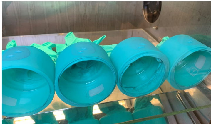
Figur 4. Utvärdering av senapsgasresistens på simulerad hand i form av en glasbägare.
